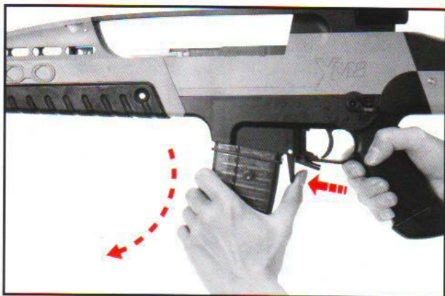
19. Stiskněte páčku pro uvolnění zásobníku. (Zásobník přidržíte - může spadnout).
